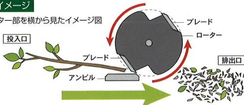
小型でコンパクトなのにハイパワー、最大40mmの太枝も強力に粉碎でき大容量の剪定枝も約1/5にスッキリ減容。
