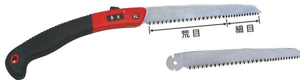
園芸・山林・果樹の剪定用。衝撃焼き入れ、ハードクローム仕様。先端部の細目で細枝を剪定、後部の荒目で太枝を剪定。
