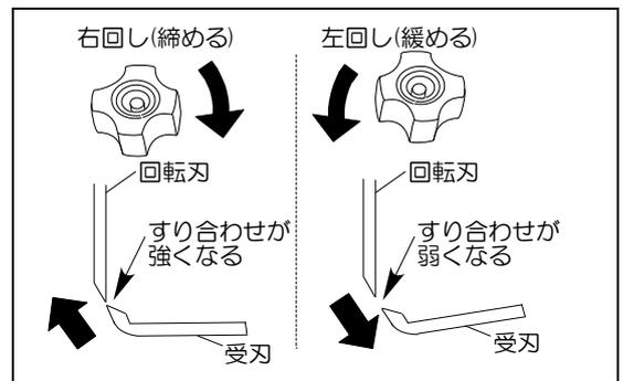
(3) コピー用紙(約0.1mm)を20~30mmの幅に切り、2枚重ね、回転刃と受刃の間に入れて、回転刃を手でゆっくりと回し、この時にコピー用紙1枚が切れて1枚が切れずに残る調整が最良です。この状態になるように、左・右・中央部全てがこの状態になるように調整します。
