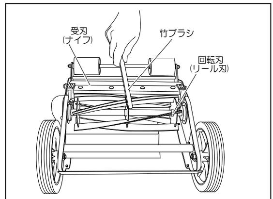
(4) 平地の安定のいい場所に、本機を上下逆(固定刃が上)に置きます。コンパウンド (付属研磨剤) を回転刃と受刃の接触面の一枚一枚に竹ブラシ (付属品) で少量塗布してください。
