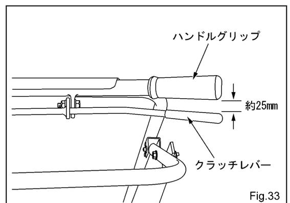
2個のロックナットにてクラッチケーブルコネクタを固定して下さい。
