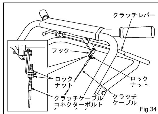
(7) クラッチレバーを放した状態（フリーの状態）にしたらクラッチが切れます。この状態で機械を軽く押し、機械が動く事を確認してください。（後輪を下げ、コアリングティンを地面から離れた状態で行って下さい）クラッチレバーをハンドルグリップに当てた状態にしたらクラッチが入ります。この状態で機械を強く押しても機械が動かないことを確認して下さい。
