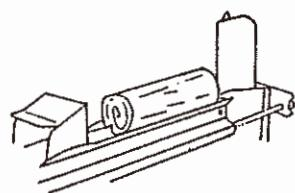
4. 操作ハンドルを下げて下さい。プッシャーが切断カッターの方に前進します。
