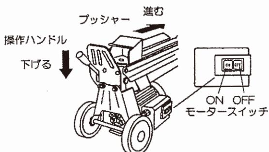
5. 作業終了後モーターOFFスイッチを押し、ポンプを停止させます。最後にエアーブリードねじを締めて下さい。
