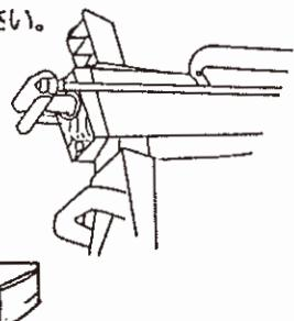
6. オイルゲージとパッキンの汚れを落とし、本体に取付けて、しっかりと締め付けて下さい。
